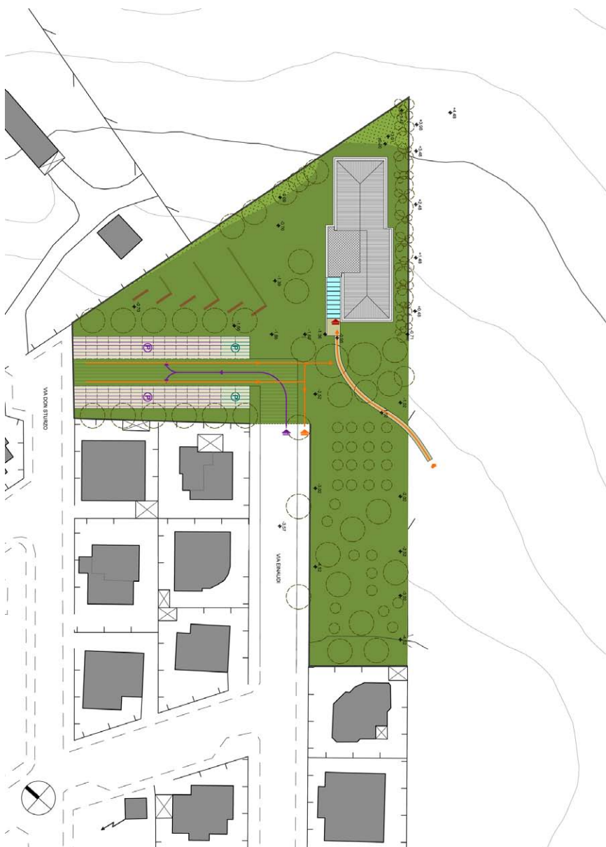
Planimetria generale con la sistemazione delle pertinenze esterne conseguente all'accorpamento dei tre lotti contermini, già nella disponibilità pubblica.
